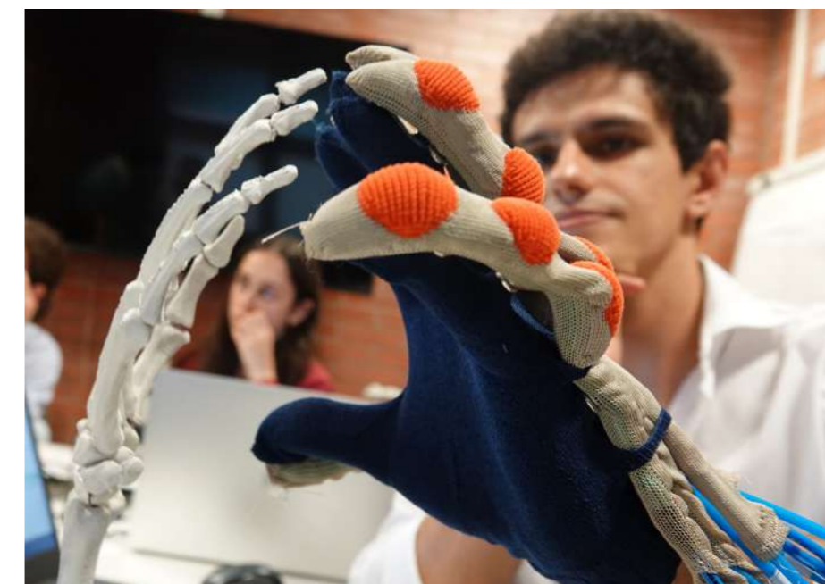
Alcune tecnologie sviluppate dal Textile Robotics Lab: tessuti elettronici uniti a sistemi di attuazione permettono di assistere il movimento delle articolazioni della mano.
