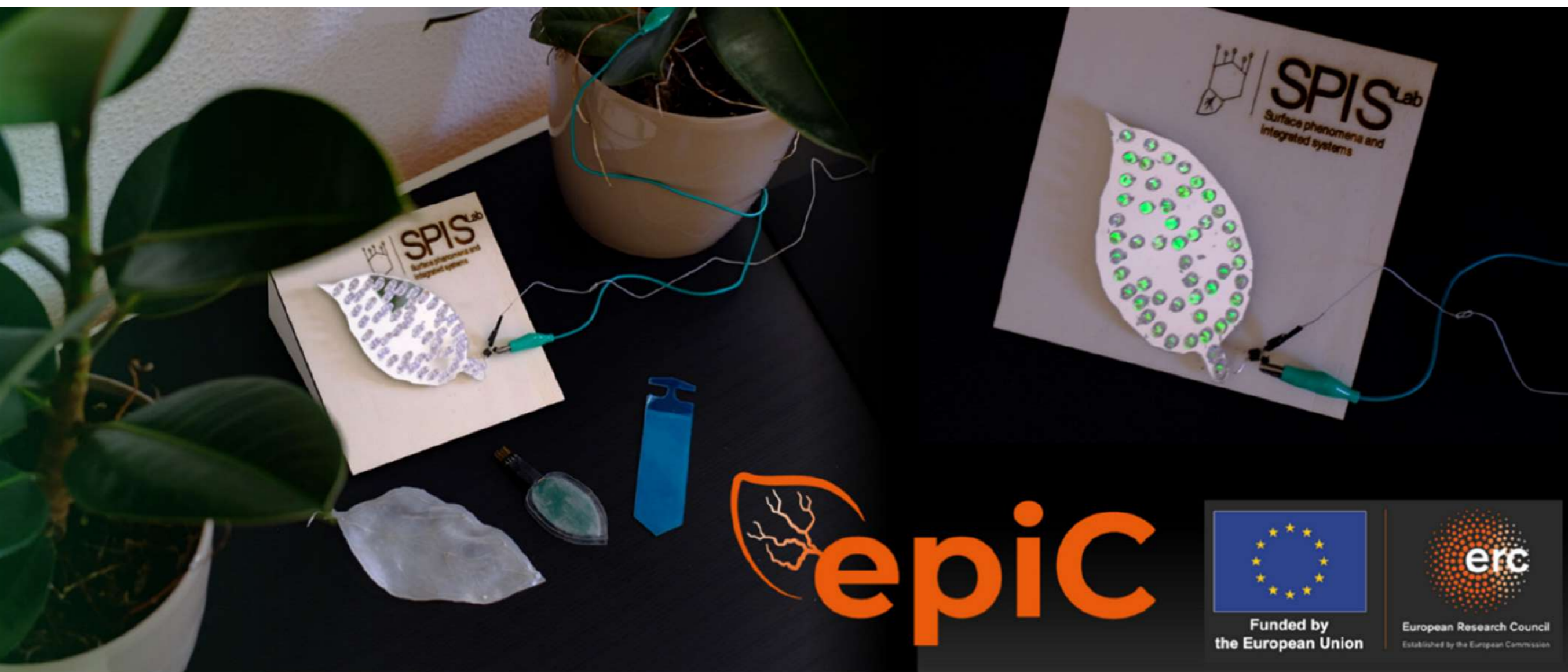
Le foglie artificiali sviluppate dal Surface Phenomena and Integrated Systems Lab, per la raccolta energetica che sfrutta il movimento delle foglie e le gocce di pioggia.
