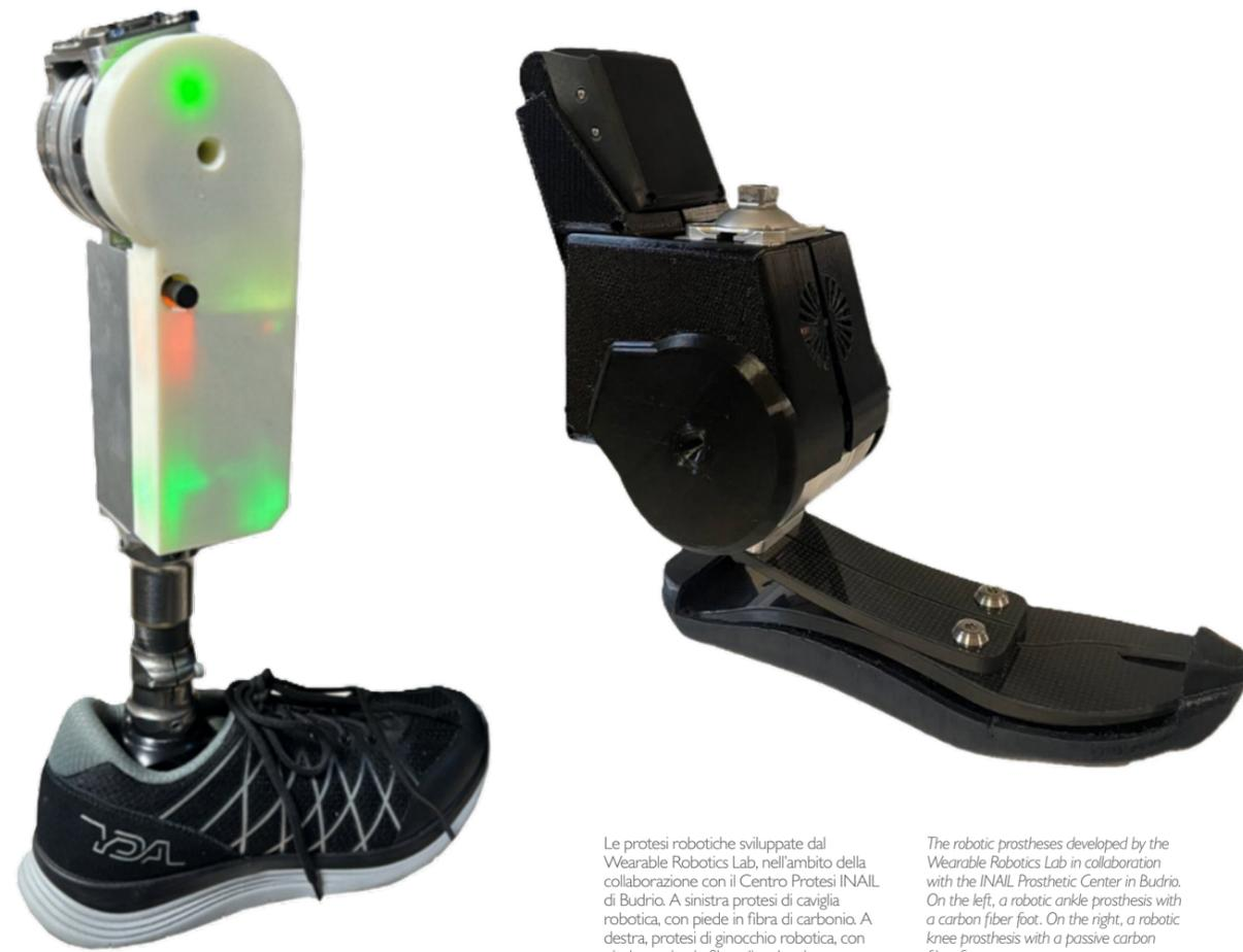
Le protesi robotiche sviluppate dal Wearable Robotics Lab, nell'ambito della collaborazione con il Centro Protesi INAIL di Budrio. A sinistra protesi di caviglia robotica, con piede in fibra di carbonio. A destra, protesi di ginocchio robotica, con piede passivo in fibra di carbonio.
